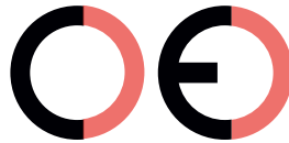
Falsche CE-Kennzeichnung (zu großer Zwischenraum)
