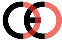
Falsche CE-Kennzeichnung (zu dicht)
